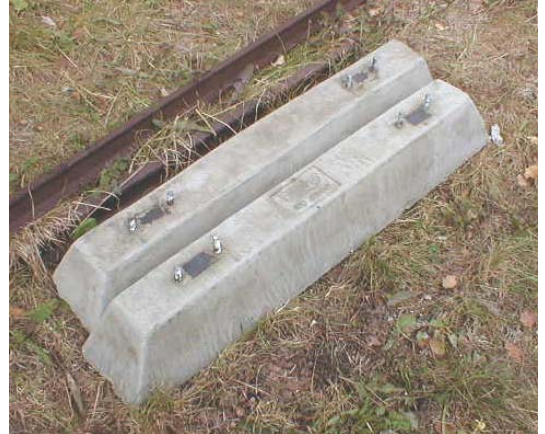
To af de første betonsveller vi har støbt.
